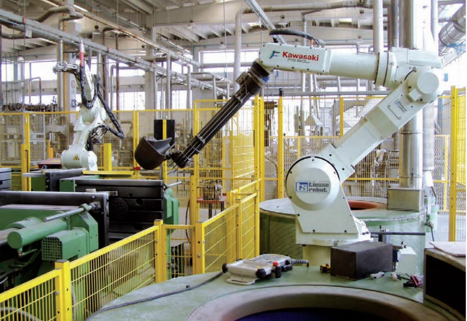
Egual apprezzamento trovano nell'ambito della colata a gravità per operazioni da dosatura alluminio od ottone e nella manipolazione dei getti con semplici isole a due o tre macchine, sistemi lineari oppure sistemi più complessi a tavola rotante.
